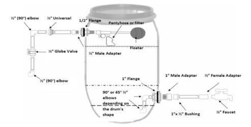
Fig. 5 Filter schematics
